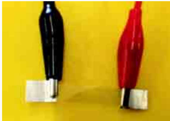
Figura 1. Forma correcta de conectar la película de ITO.
