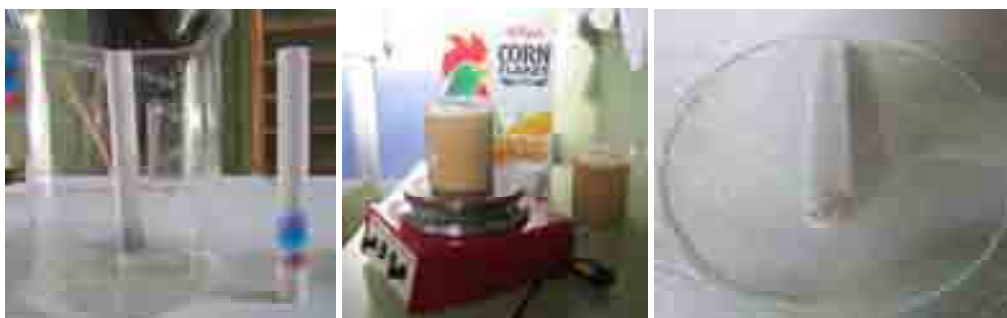
Figura 4. Cromatografía y extracción del hierro de los cereales en la segunda sesión.
