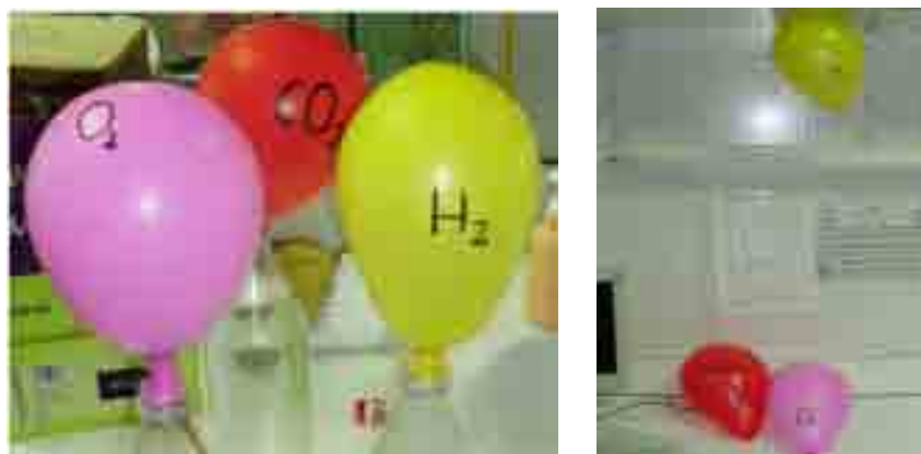
Figura 1. Globos en la boca de las botellas en las que se generan los gases y demostración de que el hidrógeno es más ligero que el aire (el globo sube) mientras que el \text{CO}_2 y el \text{O}_2 son más pesados.
