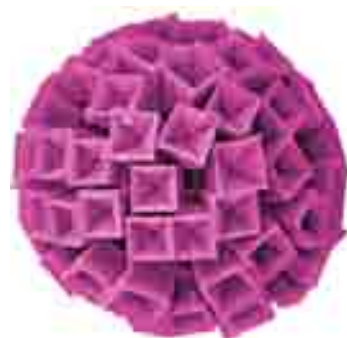
Figura 5. Micrografía electrónica de cloruro sódico (9), tomada de: Chemical and Engineering News, 23- 5- 2011, p.10.
