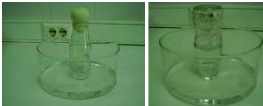
Figura 3. Por variación de la presión de vapor del agua el huevo entra dentro de la botella o el agua sube por el interior de la misma.
