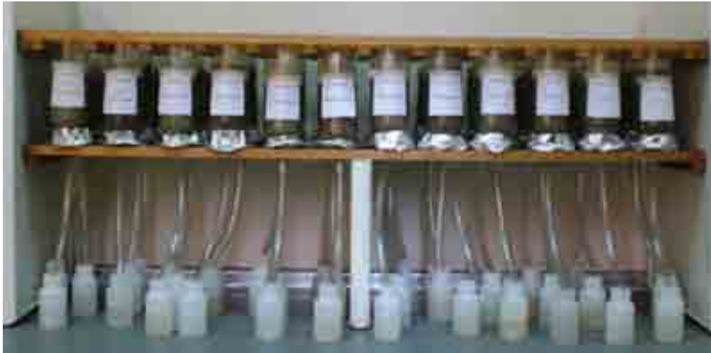
Figura 6. Ensayo en columnas de lixiviación con ácidos orgánicos de bajo peso molecular.
